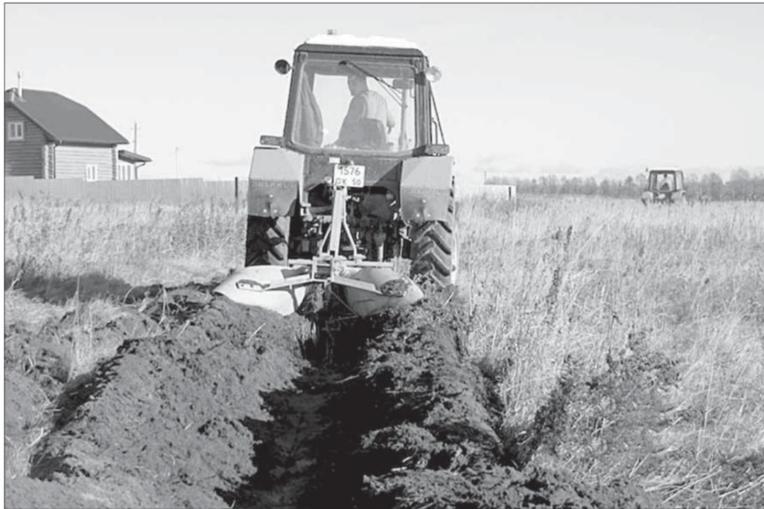
Один из основных способов предотвращения перехода природного пожара на строения - создание минерализованных полос между лесом и населенным пунктом.
